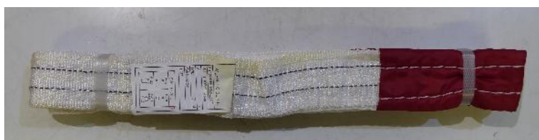
Bild 4: Falsche Farbcodierung des Bandes entgegen der angegebenen DIN EN 1492-1. (Foto: FSA)
